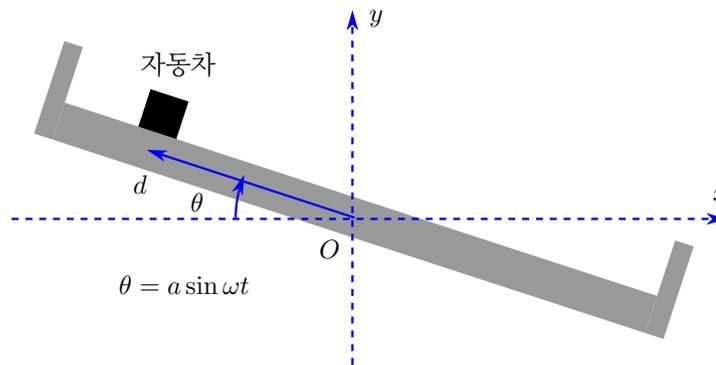
다리의 휘청거림은 원점  $O$ 를 중심으로 한 회전각  $\theta$ 로 표현하며, 다리는  $\theta = a \sin \omega t$ 로 ( $|a| < \pi/2$ ) 휘청이고 있다고 가정하자. 자동차는 원점으로부터  $d$ 의 거리에 주차브레이크가 걸린 채 정차해 있으며, 자동차와 다리 사이의 마찰력은 운동마찰계수  $\mu_k$ 로 표현된다. 중력가속도  $g$ 는 수직 하방인  $-y$  방향으로 작용한다.
